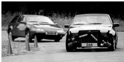
Рис. 25. Пример механической подвески DAS, препятствующей наклону корпуса автомобиля на повороте. На открытой передней части автомобиля видны дополнительные устройства и пружины подвески. Сзади для сравнения с наклоном движется автомобиль без такой системы (фотография взята из Интернета).
