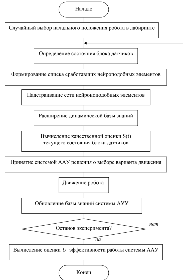
Рис. 7. Алгоритм оценки эффективности работы системы ААУ при движении робота в лабиринте.
