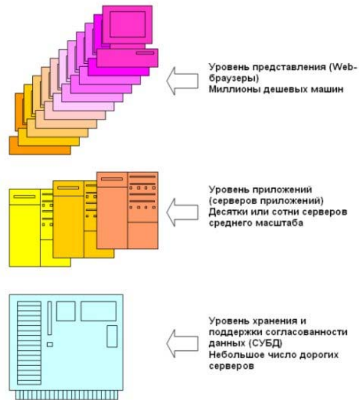
Рис. 9. Традиционная трехзвенная архитектура организации приложений баз данных
