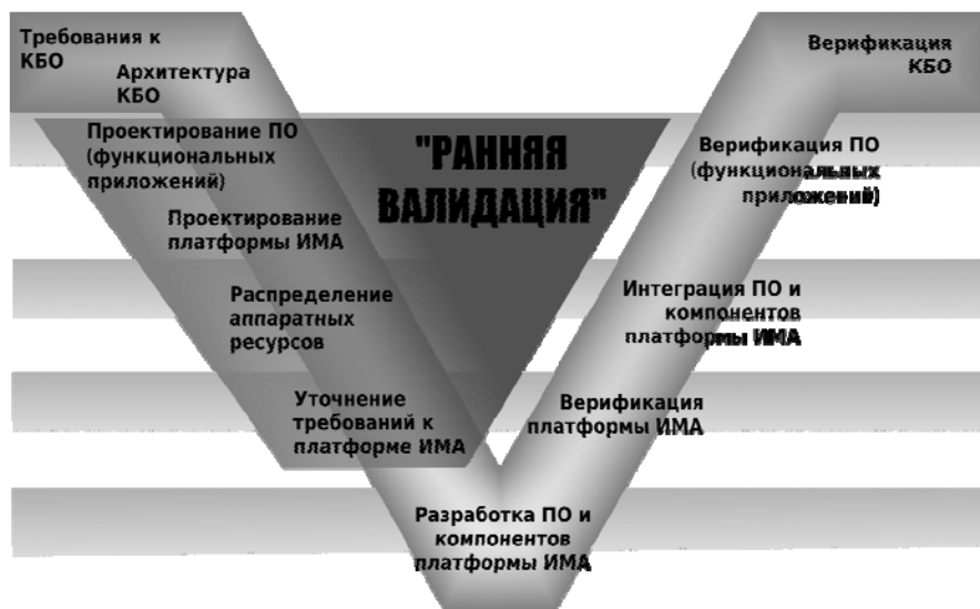
Рисунок 2. Место ранней валидации в процессе проектирования и разработки платформы ИМА
