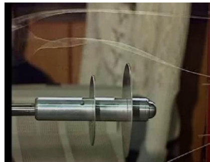
Рис. Дозвуковая труба МГТУ им. Н.Э. Баумана Т-500 и установка свободных колебаний. V=22-30 м/с. Re=(2-8) \cdot 10^5 .
