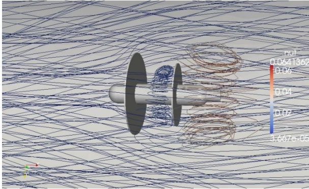
Рис. Значения турбулентной вязкости.
