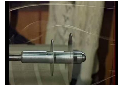
Рис. Дозвуковая труба МГТУ им. Н.Э. Баумана Т-500 и установка свободных колебаний. V=22-30 м/с. Re=(2-8) \cdot 10^5 .
