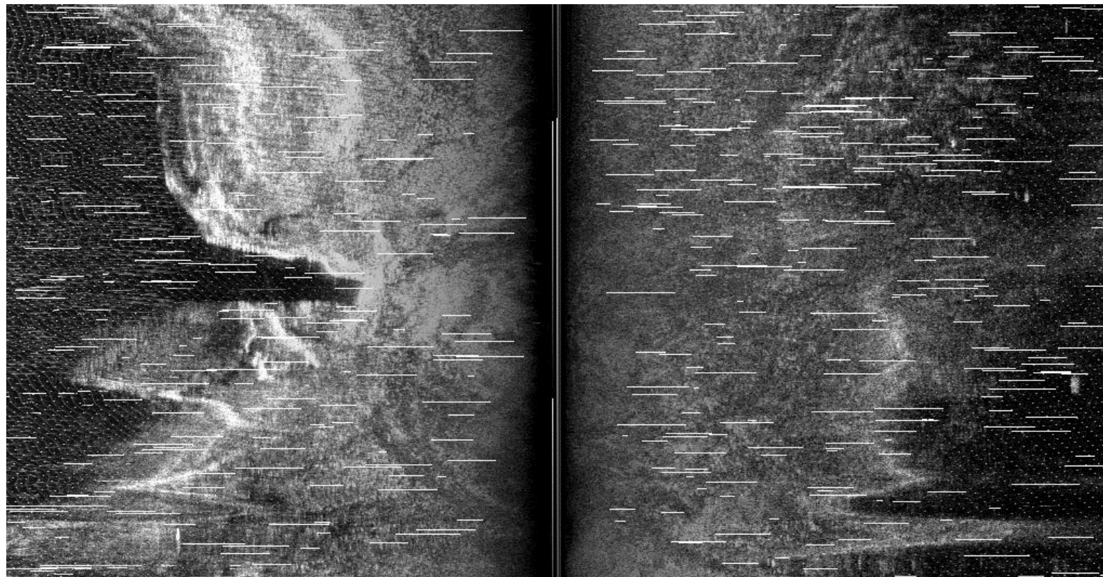
Рис. 1 Фрагмент эхолокационного изображения, полученного с помощью гидролокатора бокового обзора, с дополнительным шумом
