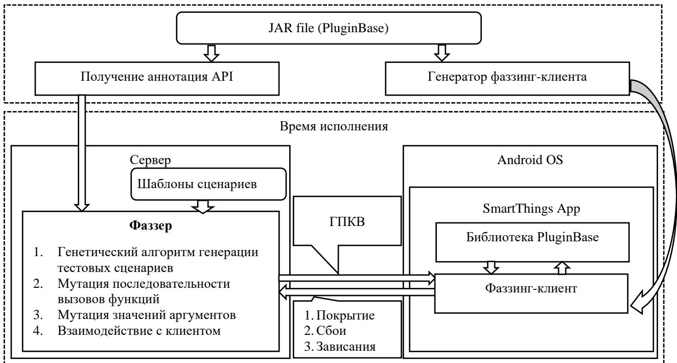
*Рисунок 2. Схема работы фаззинга интерфейсных функций*
