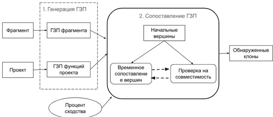
Рисунок 1. Схема нахождения клонов фрагмента кода.
