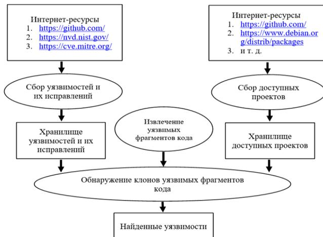
Рисунок 4. Схема нахождения клонов известных уязвимостей.
