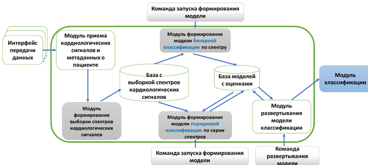
Рисунок 11 - Схема архитектуры фреймворка для формирования модуля классификации по спектрам кардиологических данных. Серым цветом выделены модули, логика которых описана во 2й главе. Синим выделен целевой результат работы фреймворка – готовый модуль классификации.
