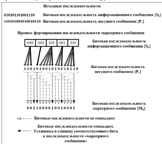
Рис.5. Схема, поясняющая процесс формирования маркерного сообщения Fig.5. Diagram explaining the process of forming a marker message
