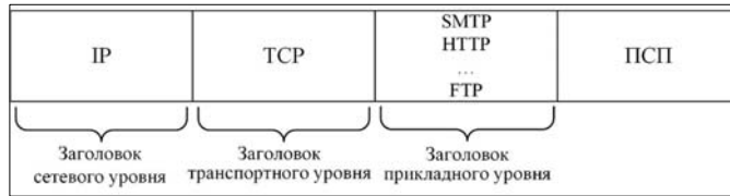
Рис. 7. Графическое изображение инкапсуляции пакета протокола скрытой передачи информации на примере стека протоколов TCP/IP
