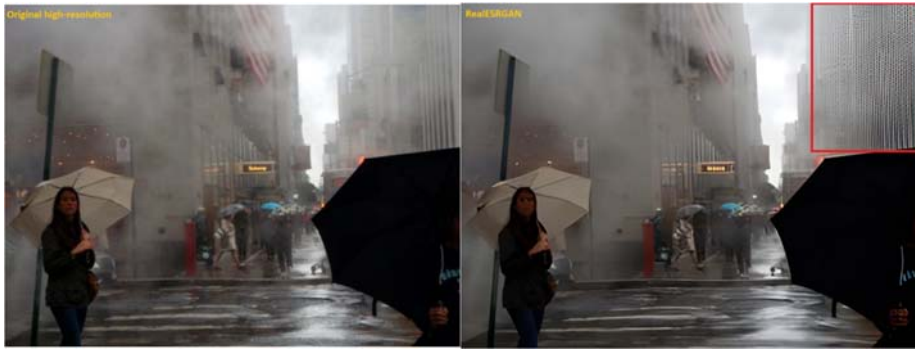
Рис. 1. Пример появления текстурного артефакта в результате применения метода суперразрешения Real-ESRGAN [1] (справа) в сравнении с оригинальным изображением высокого разрешения (слева).
