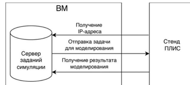
Рис. 3. Схема системы косимуляции для удаленного стенда. Fig. 3. Schematic diagram of the co-simulation system for a remote testbed.
