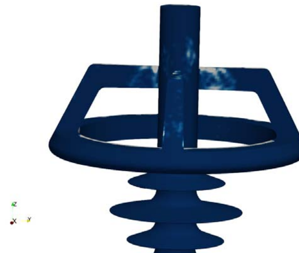
Рисунок 7 - Положение льда на изоляторе. Вид сзади. t=200 секунд. Fig. 7 The position of the ice on the insulator. Rear view. t=200 seconds.
