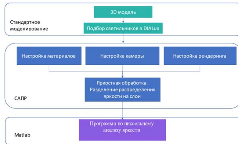
Рис. 7. Методика расчета, представленная в виде алгоритма. Fig. 7. Calculation methodology presented as an algorithm.
