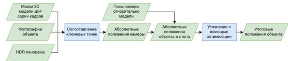
Рис. 8. Схема метода реконструкции положения объекта в сцене.
