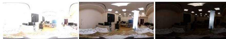
Рис. 6. Панорамные фотографии для построения модели освещения посредством HDR-съёмки на месте объекта с разницей в выдержке более 1000\times .
