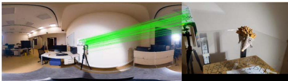
Рис. 9. Сопоставление ключевых точек на панораме и снимке объекта. В качестве маркера используется нумерованная съёмочная хлопушка с нанесённым орнаментом.
