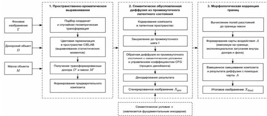
Рис. 2. Схема контекстно-ориентированного встраивания объектов. Fig. 2. Context-oriented object insertion scheme.
