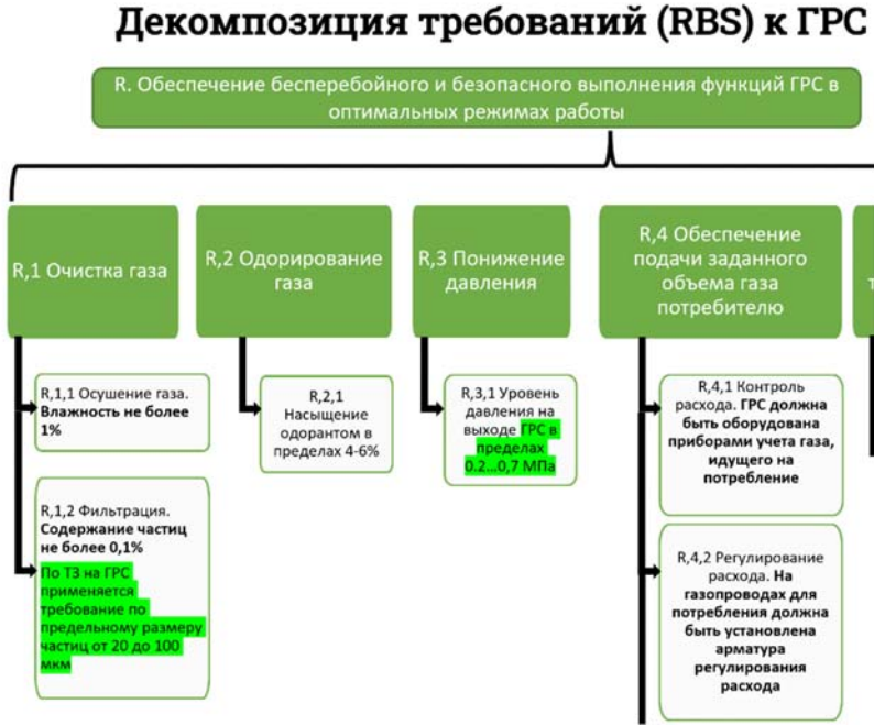
Рис. 5. Пример иерархической декомпозиции верхнеуровневого требования. Fig. 4. An example of hierarchical decomposition of a top-level requirement.
