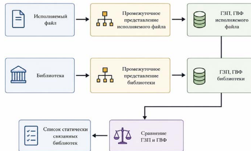
Рис. 2. Схема сравнения исполняемого файла с одной библиотекой. Fig. 2. Flowchart of executable file comparison with a single library.
