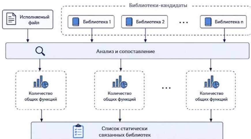
Рис. 1. Схема идентификации статически связанных библиотек. Fig. 1. Workflow of Statically Linked Library Identification.
