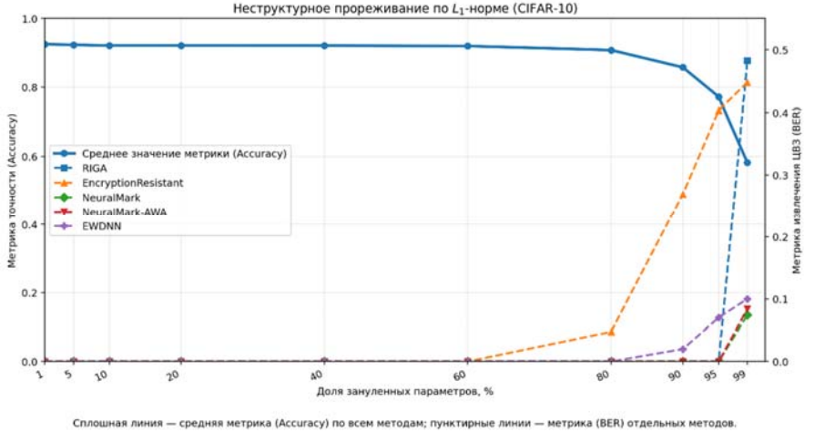
Рис. 3. Атака неструктурного прореживания по L1-норме на методы маркирования нейронных сетей. Fig. 3. Unstructured L1-norm pruning attack on neural network watermarking methods.
