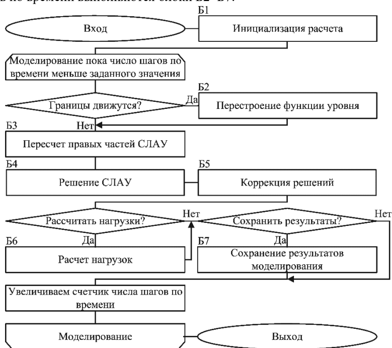
Рис. 1. Блок-схема работы программного комплекса «LS-STAG_turb»
